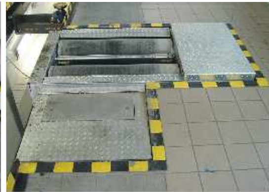
Spezialausführung des Stoßdämpferprüfstandes für den Einsatz in kombinierten Prüfstrassen für PKW und LKW
