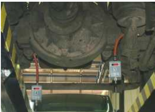
Druckluftbremstester mit 5 Mesköpfen
